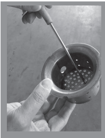
Abb. 7: Reinigung des Aschekastens
