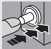
Abb. 3c: Betätigen des Piezo- Druckknopfes
