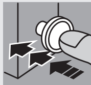
Fig. 3b : Appuyer sur le bouton de la soupape à gaz de l'
