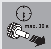
Fig. 3d : Attendre et relâcher le bouton de la soupape de gaz
